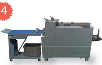
4 用紙を機械の給紙台にセットし、ダイカット作業をします
