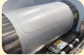
ダイプレートはかんたんに位置合わせ出来ます。マグネットシリンダーの磁気を利用してダイプレートをシリンダーに貼り付けます。プレートは鉄の薄い板ですので、置き場所にも困りません。
